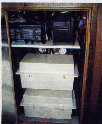
L'impiantistica è ben curata: questo è il vano batterie, poste in casse stagne, con accesso dalla cabina di poppa. L'inverter è di serie.
