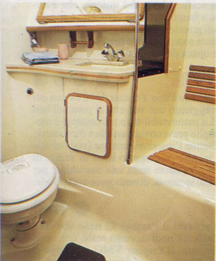
Questo è il bagno di prua, un pezzo monolitico in vtr. Da notare il comodo sedile doccia rivestito in teak.
